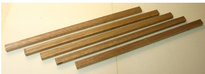
De basis voor 1 schot, 5 balkjes (hard-)hout van 400mm x 16mm x 12mm
