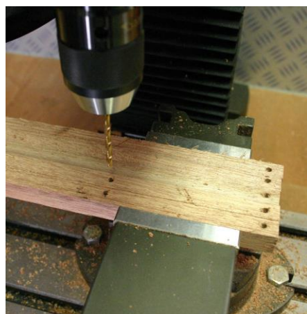
In de kolomboormachine gaatjes van 4mm geboord
