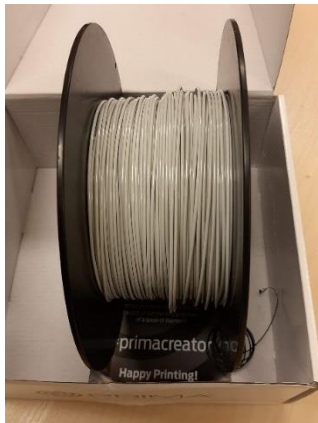
3D Filament, het materiaal wat gebruikt wordt om te printen zit op een rol van verschillende lengtes, diktes en kleur, alles afhankelijk van de printer.
