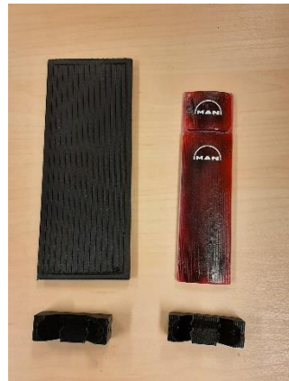
Hierboven een aantal onderdelen welke zelf zijn getekend en geprint. Let ook even op de verschillende kleuren.
